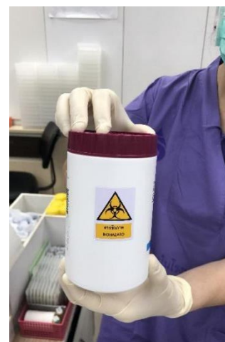
รูปที่ 8 การบรรจุ ถุง zip lock (secondary container) ลงในกระป๋องพลาสติก (tertiary container)
